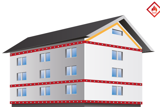
Abbildung 21: 3. Brandriegel in Doppelfunktion auch als Abschlussriegel
