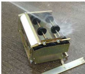
3.8 Nach Arbeitsende die VD-Mörtelrolle gründlich mit viel Wasser reinigen.
