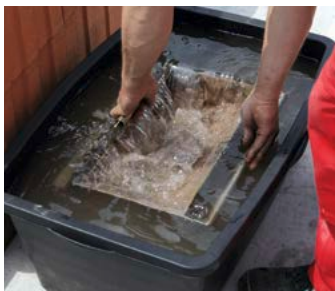
3.7 In längeren Arbeitspausen die leere Rolle im Wasserbad lagern. So trocknet der Mörtel nicht an. Wenn's wieder weitergehen soll, einfach das Wasser aus der Mörtelrolle schütten.
